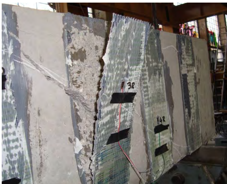
Σχήμα 4.16 Μορφή αστοχίας δοκιμίου RB200S
