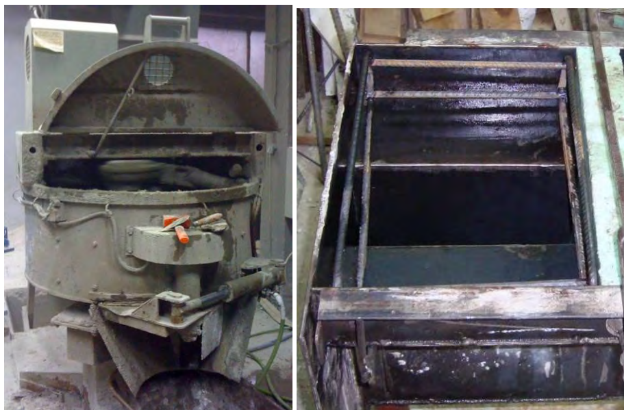
Σχήμα 3.9α Κατασκευή δοκιμίων απλών τιμημάτων διατομών πλακοδοκού
