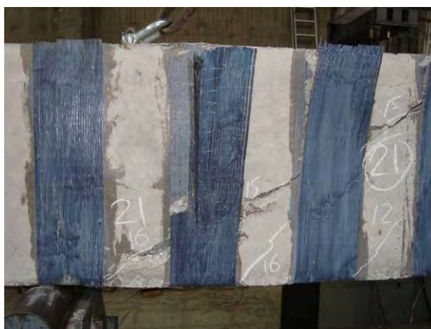
Σχήμα 4.10 Μορφή αστοχίας δοκιμίου RB200C
