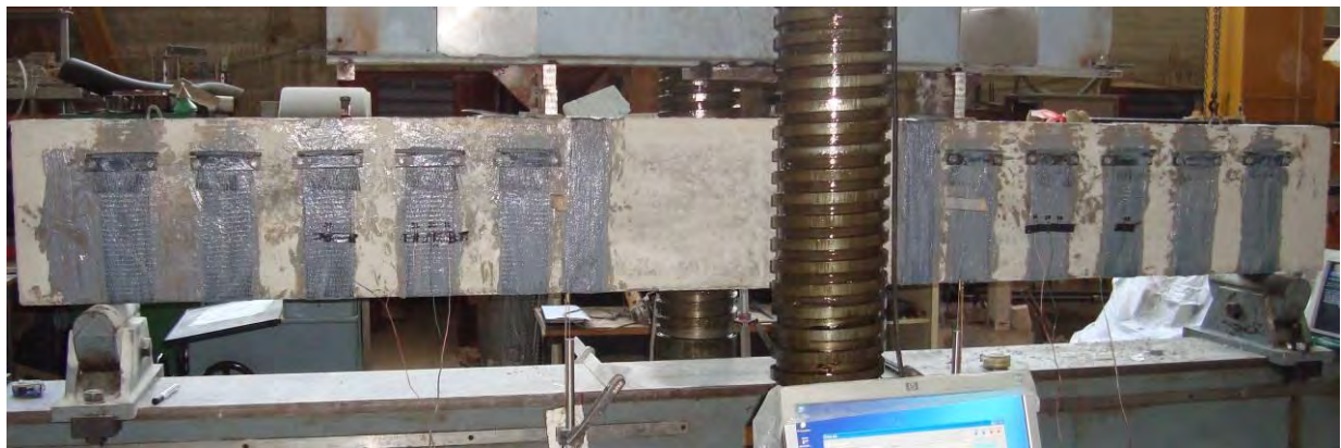
Σχήμα 4.18 Θέσεις τοποθέτησης ταινιών παραμόρφωσης
