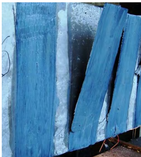
Σχήμα 4.22 Μορφή αστοχίας δοκιμίου RB150C
