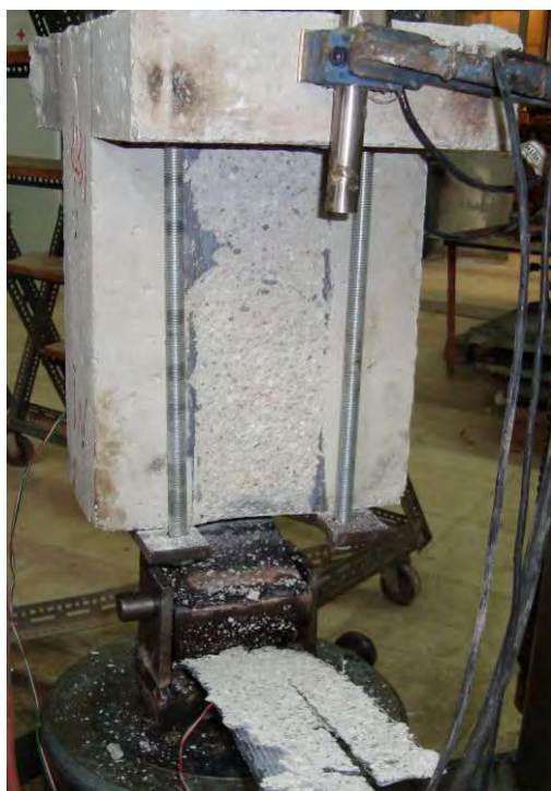
Σχήμα 4.3 Μορφή Αστοχίας CSN1
