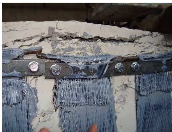
Σχήμα 4.32 Μορφή αστοχίας δοκιμίου RB150Sa
