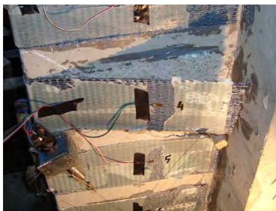
Σχήμα 4.36 Σχήμα αστοχίας Δοκιμίου δοκιμίου TB150
