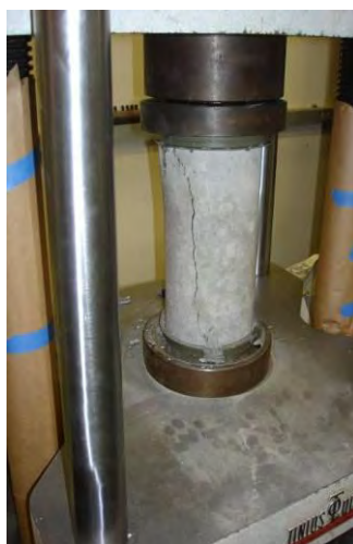
Σχήμα 3.1 Θλίψη κυλινδρικών δοκιμίων σκυροδέματος
