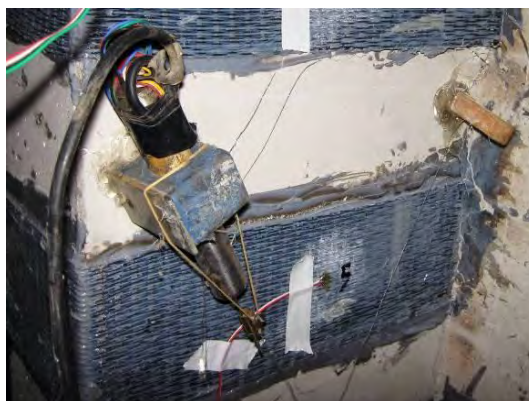
Σχήμα 4.39 Σχήμα αστοχίας Δοκιμίου TB150
