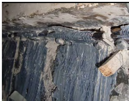
Σχήμα 4.55 Σχήμα αστοχίας Δοκιμίου δοκιμίου TB150-R
