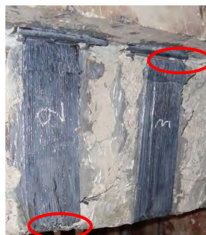
Σχήμα 4.58 Σχήμα αστοχίας Δοκιμίου TB200-R
