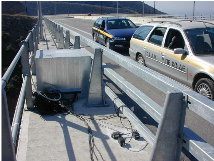
Φωτογραφία Δ.7 Κεντρική μονάδα κινητού συστήματος επιταχυνσιόμετρων και τρία επιταχυνσιόμετρα στο κεντρικό άνοιγμα της 2 ης χαραδρογέφυρας Καβάλας.
