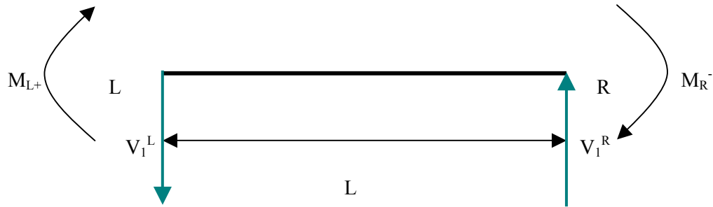
Σχήμα 4.2 Τέμνουσες λόγω ανάπτυξης ροπών-στις ακραίες διατομές- ίσων με τις «δεξιόστροφες ροπές αντοχής»
