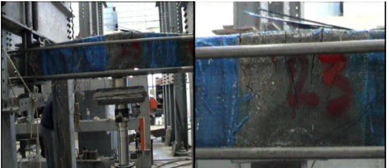
Σχήμα Β10 Μορφή αστοχίας δοκιμίου Α2-Δ-ΕΕ. (Σχηματισμός πλαστικής άρθρωσης στη θέση άσκησης του φορτίου και στη μεσαία στήριξη.)
