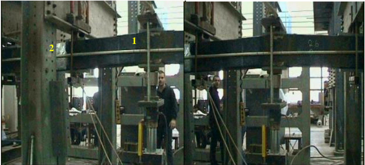
Σχήμα Γ13 Μορφή αστοχίας δοκιμίου Γ4-Δ-Ε. (Σχηματισμός πλαστικής άρθρωσης στη θέση άσκησης του φορτίου (1) και στη μεσαία στήριξη (2).)
