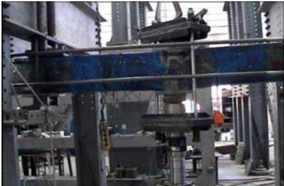
Σχήμα Β4 Μορφή αστοχίας δοκιμίου Α1-ΤΘΔ-ΕΕ. (Σχηματισμός πλαστικής άρθρωσης στη θέση άσκησης του φορτίου και στη μεσαία στήριξη, αστοχία εφελκυσμένου χάλυβα.)
