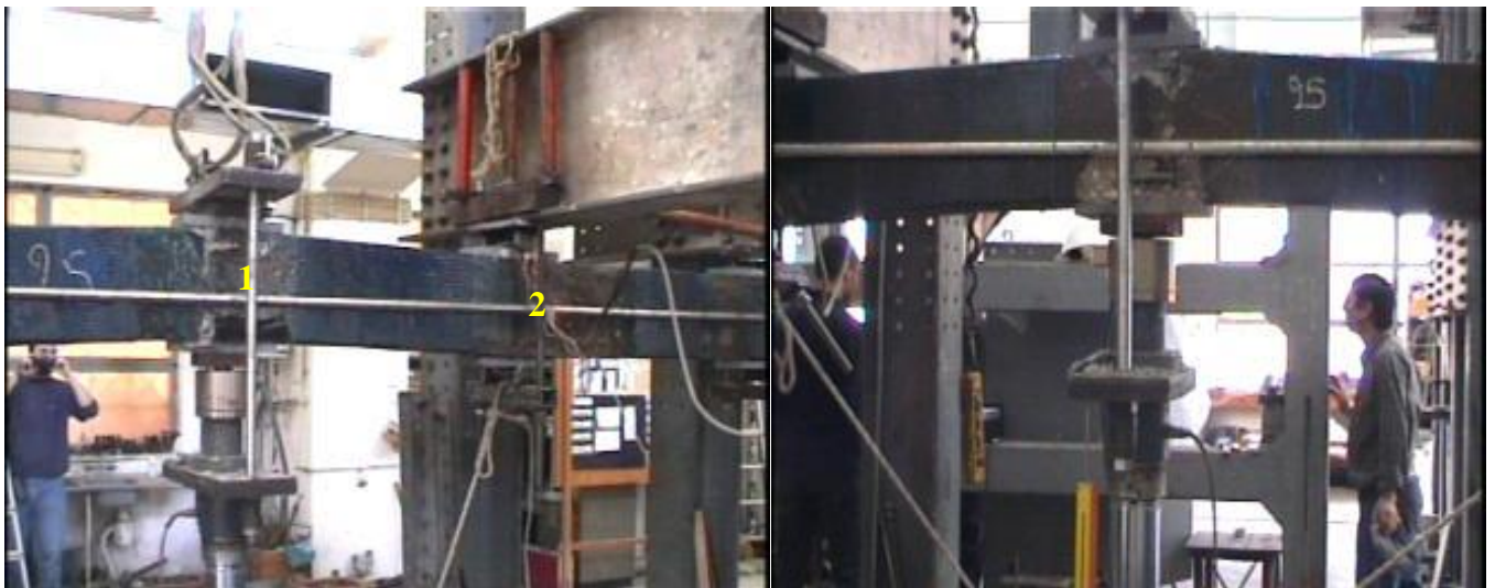
Σχήμα Γ10 Μορφή αστοχίας δοκιμίου Γ3-Δ-ΤΘΔ-Ε. (Σχηματισμός πλαστικής άρθρωσης στη θέση άσκησης του φορτίου (1) και στη μεσαία στήριξη(2).)
