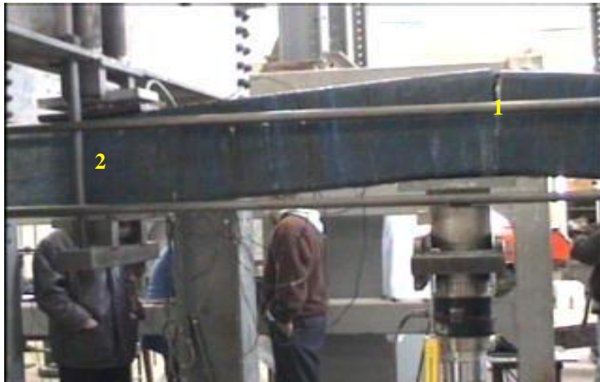
Σχήμα Δ13 Μορφή αστοχίας δοκιμίου Δ3-E-Δ. (Θέσεις αναμενόμενων πλαστικών αρθρώσεων: (1) θέση άσκησης του φορτίου και (2) μεσαία στήριξη.)
