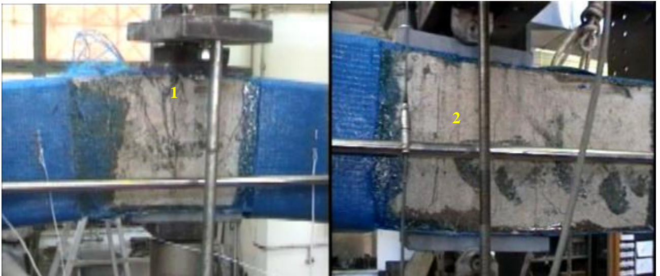
Σχήμα Γ7 Μορφή αστοχίας δοκιμίου Γ2-Δ-E. (Σχηματισμός πλαστικής άρθρωσης στη θέση άσκησης του φορτίου (1) και στη μεσαία στήριξη (2).)
