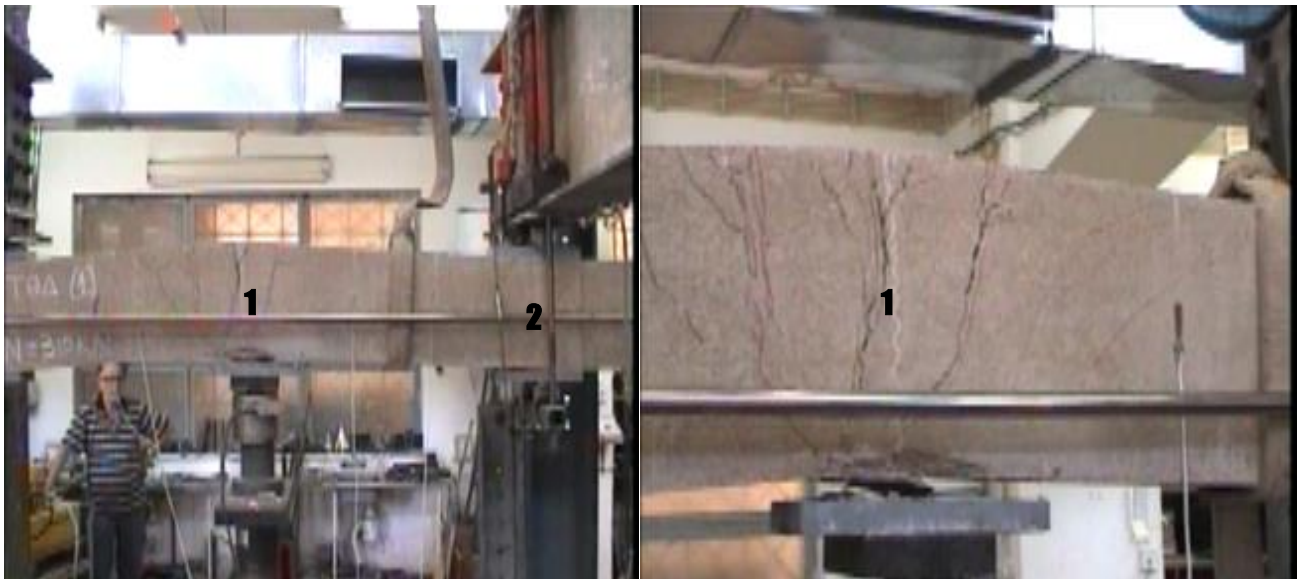
Σχήμα Α6 Μορφή αστοχίας δοκιμίου Α1-ΤΘΔ. (Σχηματισμός πλαστικών αρθρώσεων στις θέσεις 1 (θέση άσκησης εγκάρσιου φορτίου) και 2 (μεσαία στήριξη).)
