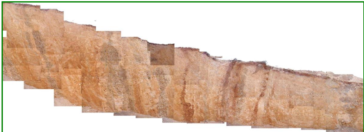
Εικόνα 3-17. Σύνθετη απεικόνιση του ανατολικού τοιχώματος της παλαιοσεισμολογικής τομής ΚΑΡ-1.
