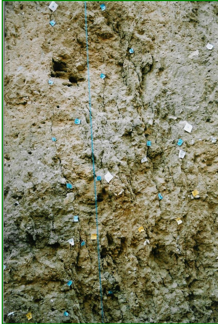
Εικόνα 2-25. Λεπτομέρεια της ρηξιγενούς ζώνης στο ανατολικό τοίχωμα της παλαιοσεισμολογικής τομής GER-5. διακρίνονται οι διαδοχικές επιφάνειες (ρωγμώσεις) που συγκροτούν τη ζώνη.
