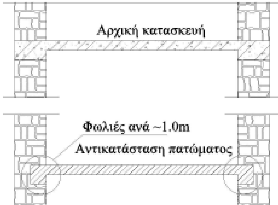
α. Πλάκες οπλισμένου σκυροδεμάτος
